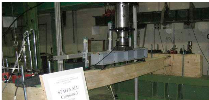
Próbák tényleges méretű mintákon (főgerenda-segédgerenda csatlakoztatása).
